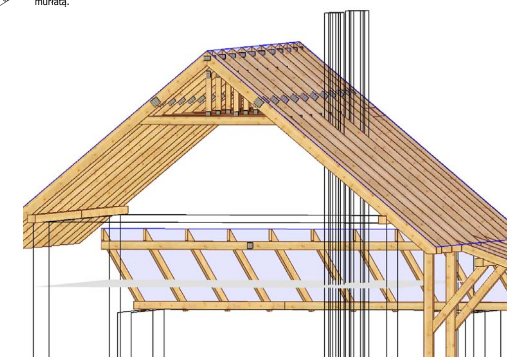
Kątownik ABR105 Simpson Strong-Tie łącznik wiązarów z murlatą.
