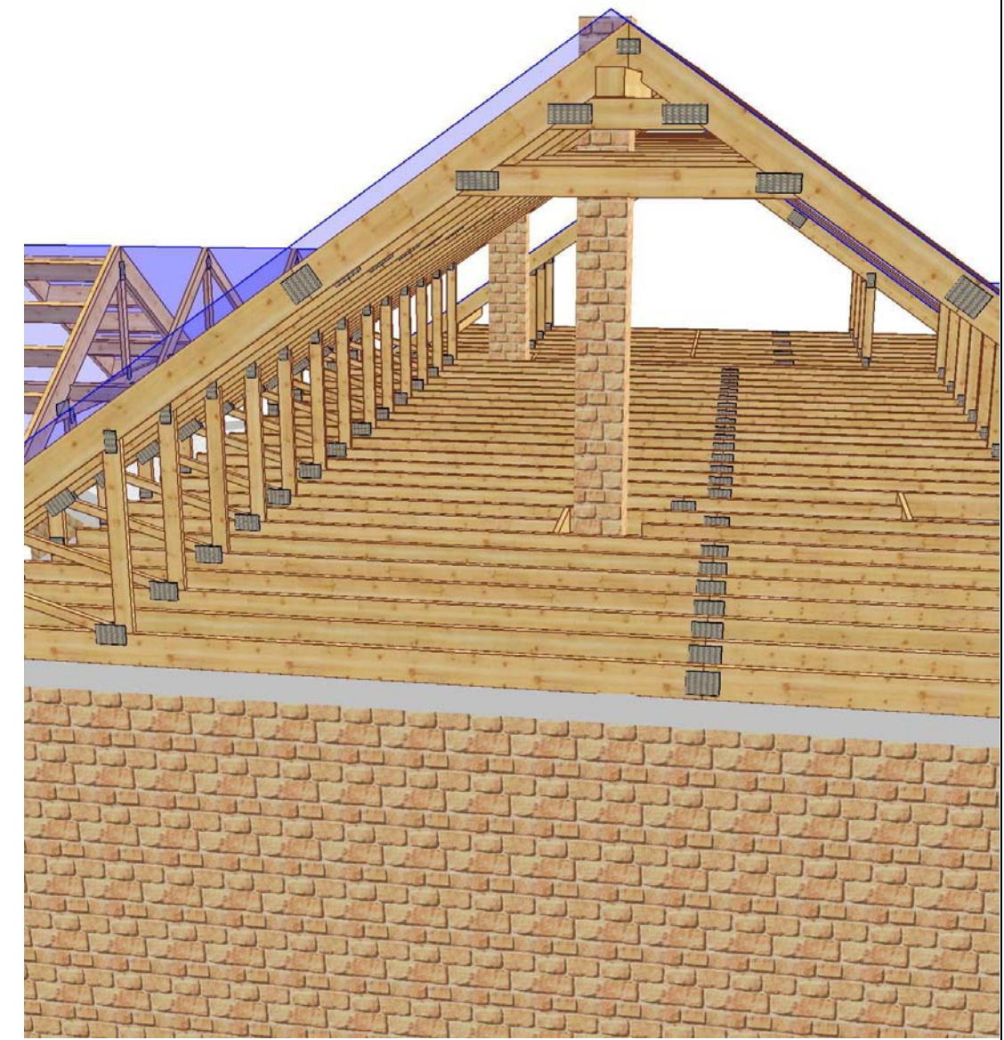
TARCICA KONSTRUKCYJNA (SOSNA, ŚWIERK) KLASY C24 gr. 45 i 60mm, SUSZONA DO WILGOTNOŚCI max.18%
